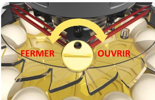
Ouverture et fermeture de la ventilation : Fermez la ventilation pour augmenter l'humidité ou ouvrez-la pour la diminuer. De manière générale, réglez au minimum lorsque vous utilisez le contrôle automatique de l'humidité.
