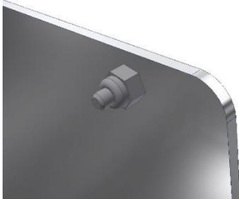
Serrez chaque écrou en tournant la vis à l'aide d'un tournevis tout en maintenant l'écrou avec une pince ou une clé.
