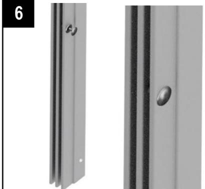
Insérez le rivet dans le trou, puis poussez-le pour le fixer.
