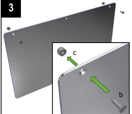
Positionnez les vis à tête fraisée (b) et les écrous (c) sur l'autre panneau de la porte. Les vis doivent être insérées par derrière dans les trous fraisés.
