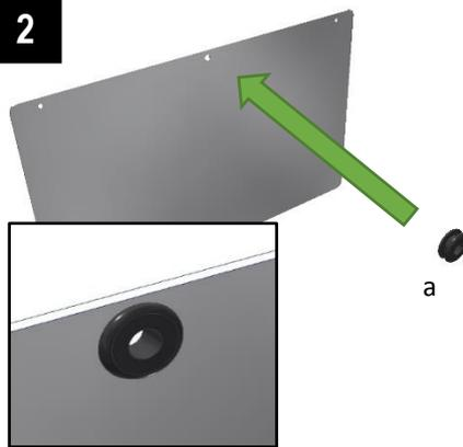
Positionnez l'œillet (a) dans le trou central de l'un des panneaux de la porte.
