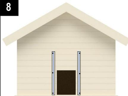
Positionnez les glissières sur le poulailler de chaque côté de l'ouverture de la porte en veillant à centrer l'ouverture par rapport aux glissières. Elles doivent être parfaitement verticales, à plat et de niveau. Les trous de fixation doivent être espacés de 322 à 325 mm.
