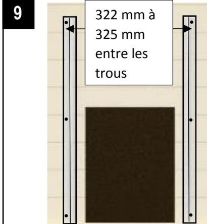
Une fois que les glissières sont verticales et que les trous sont espacés de 322 à 325 mm, marquez les emplacements des six fixations. Percez des trous d'un diamètre de 1,5 mm.
